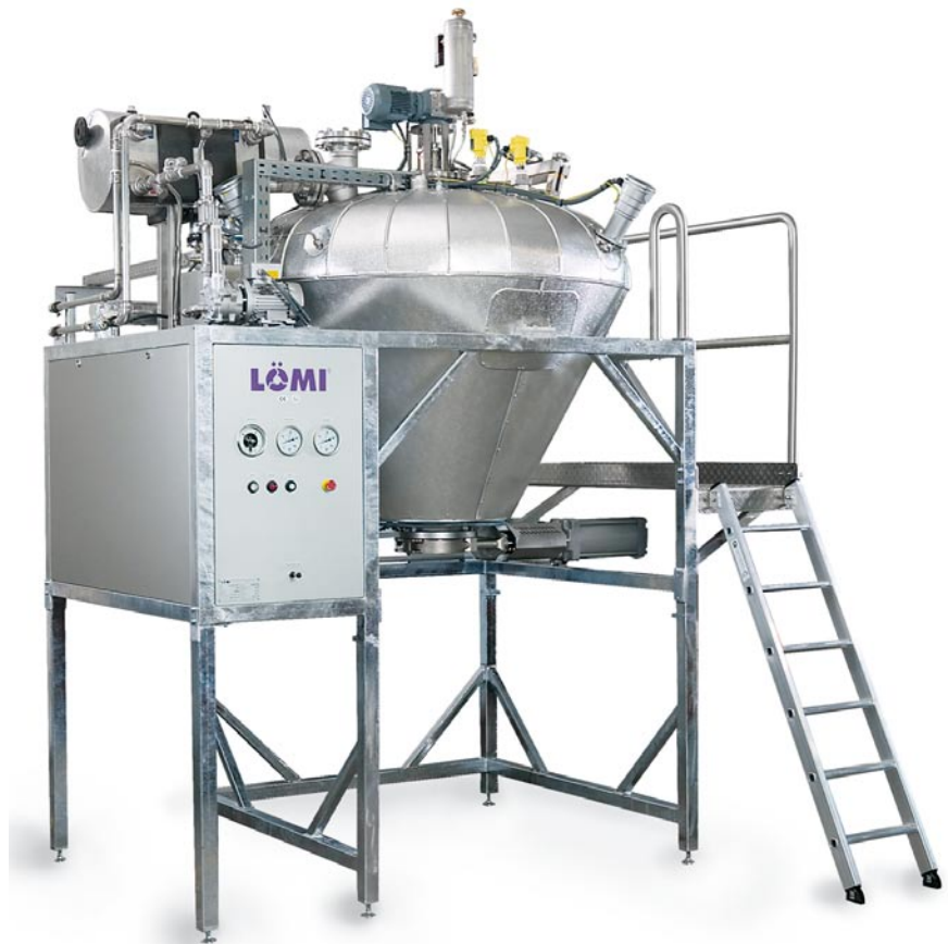
Für große Aufbereitungsmengen kommt eine vollautomatische Rührwerksanlage zum Einsatz. Bei 200 Litern pro Tag amortisiert sich eine innerbetriebliche Aufbereitungsanlage in der Regel bereits innerhalb eines Jahres.
